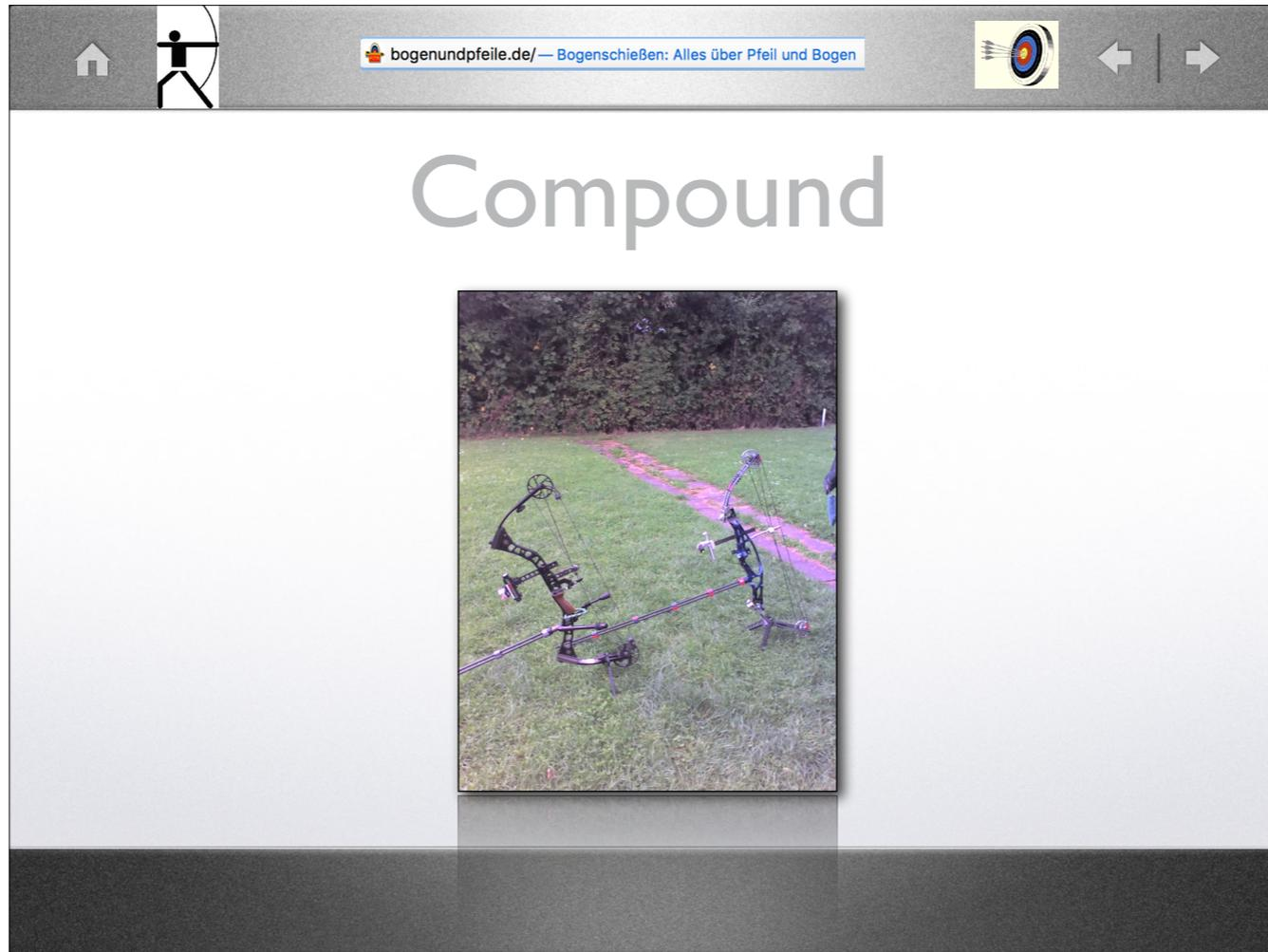
Der Compound – Bogen ist ein moderner Bogen der dem Bogenschützen eine Vielzahl von Hilfen anbietet (Visier, Wasserwage, Peep) und über die Umlenkrollen eine Zuggewichtsreduzierung im Auszug bietet.
